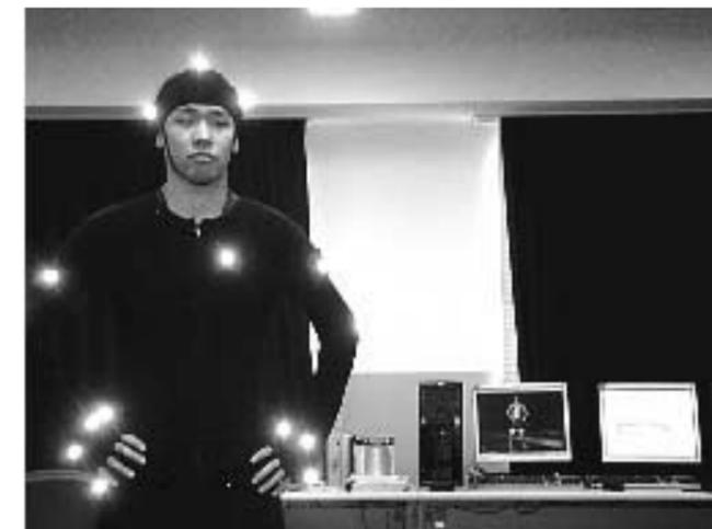
モーション・キャプチャー：マーカをつけた人の動き(モーションデータ)を、8台のカメラで1秒間に最大200コマの画像を撮り、マーカの3D位置を検出することによって、リアルタイムに取り込みます。この装置を用いてダンス動作やピアノ演奏の解析やアニメーション生成を行っています。
