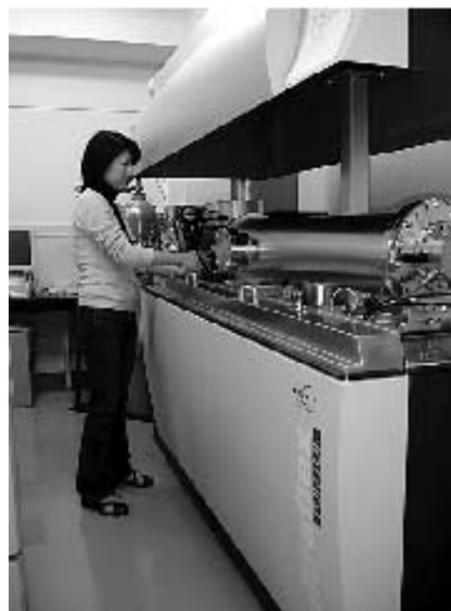
飛行時間型質量分析装置(TOF-MS/MS)：細胞で機能している特定のタンパク質を見つけた(プロテオーム解析)、タンパク質の修飾を瞬時に解析できる装置です。
